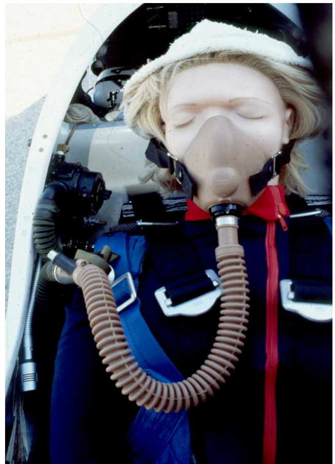
"Diluter demand"-Anlage mit bulkigem, rein mechanisch höhengeregeltem O 2 /air-Mixer und dem lästigem Faltschlauch. Würde ab 7'600 m 100 % O 2 eingeatmet, so verlassen noch 95 % O 2 das System mit jeder Ausatmung.
