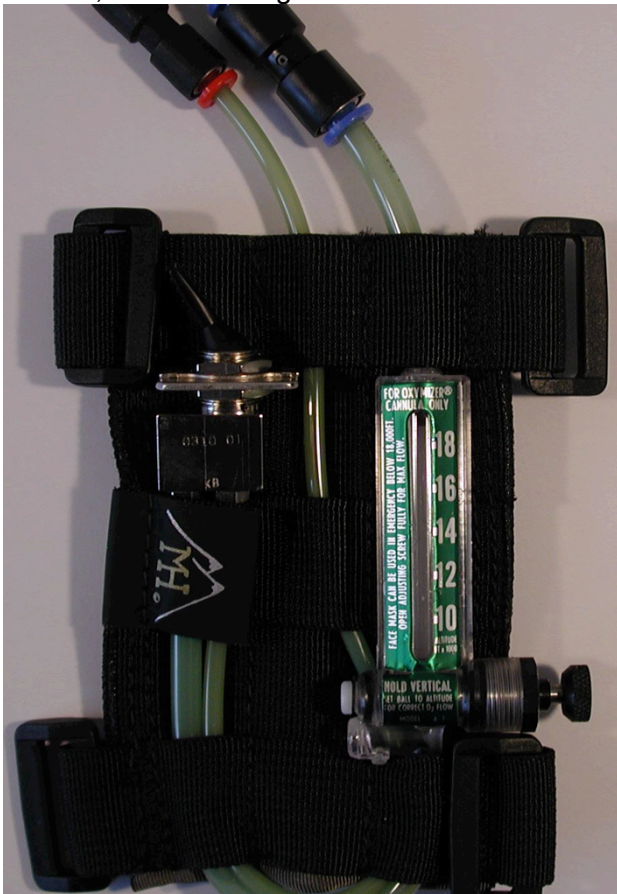
Nelson A3-Flowmeter mit Haupthahn zur Kombination mit den Oxymizer-Nasenkanülen. Der benötigte O 2 -flow ist von 10'000 bis 18'000 ft graduiert und muss mit dem Drehknopf im rechten untern Bildviertel dosiert werden.
